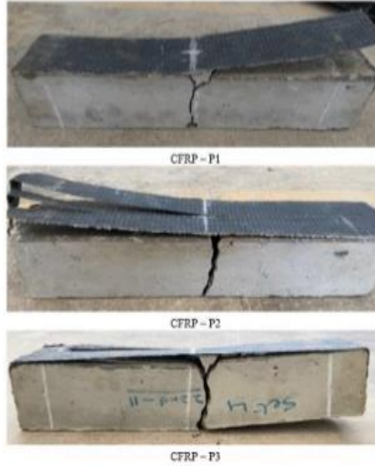
CFRP (Sika Wrap 230 C + Sikadur 30)
